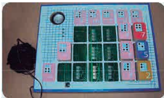
Fig. 1. Versión original del panel electrónico implementado para enseñanza de operaciones matemáticas básicas a niños con capacidades visuales especiales, (Diseño del Material Didáctico Matemático y Discapacidad Visual en niños de educación básica).
