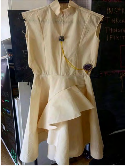
Figura 3. Wearable con placa lilypad y sensor acoplados (Autores: Suzete Venturelli, Tainá Louise Martins y Artur Cabral Reis, 2018).
