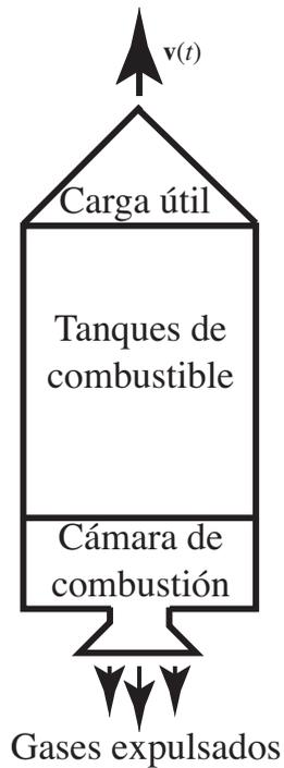
Figura 2.4: Diagrama esquemático de un cohete. El símbolo  $v(t)$  designa la velocidad del cohete.
