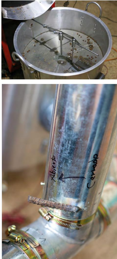
**Figura 6.** Modificaciones recientes a la tostadora JL en la asociación De Finca. Implementación de tubo extractor de material particulado y cáscara (abajo) e implementación de aspas de aluminio con motor para acelerar el proceso de enfriado del café recién tostado (arriba), vereda Guavio Alto (24 de enero de 2019)
