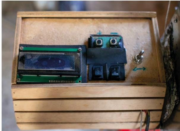
**Figura 3.** Tablero de funcionamiento de placa Arduino adecuada a la tostadora JL, asociación De Finca, vereda Guavio Alto (8 de octubre de 2018)
