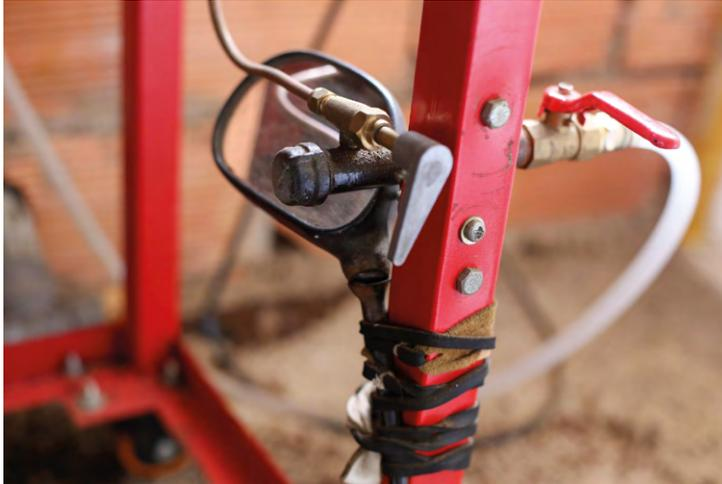
**Figura 4.** Adecuación de espejo retrovisor de moto a tostadora JL, asociación De Finca, vereda Guavio Alto (8 de octubre de 2018)
