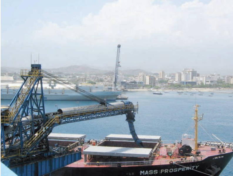
Figura 1.5. Banda transportadora y embarque directo de carbón en el puerto de Carbosán, en la bahía de Santa Marta (fotografía: Andrés Franco-Herrera).
