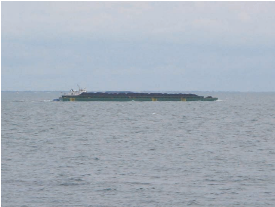
Figura 1.9. Ejemplo de barcaza que se utiliza en la zona costera del departamento del Magdalena, para el transporte de carbón desde el muelle de embarque hasta los buques carboneros y que han naufragado en diferentes sectores de la plataforma continental (fotografía: Andrés Franco-Herrera).
