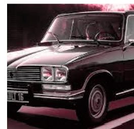
Renault 16: El primer modelo de automóvil con carrocería liftback
