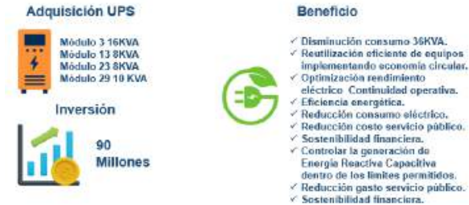
Imagen 2. Renovación infraestructura eléctrica en la red regulada. Fuente propia. 2025.
